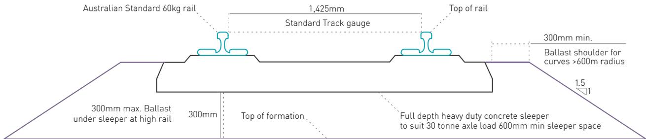
TYPICAL TRACK FORMATION CROSS SECTION (STANDARD GAUGE)
